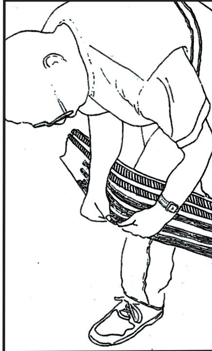
**C.** Al doblar el radio estándar (el radio utilizado en una piscina rectangular), la forma puede doblarse sobre su rodilla. Use sus antebrazos para doblar mientras mantiene rígido el borde superior de la forma, evitando cualquier vuelco.
