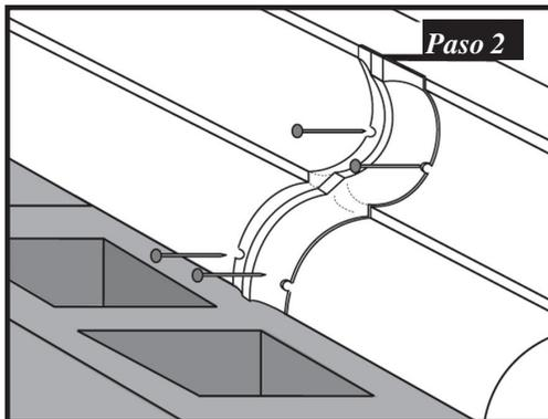
**Paso 2.** Coloque el Chamfer Clip en la forma y fíjelo con los clavos provistos.
