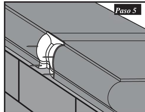
**Paso 5.** Pele la forma de la tapa de la pared, exponiendo el Chamfer Clip. Retire con cuidado el Chamfer Clip y límpielo inmediatamente para volver a usarlo.
