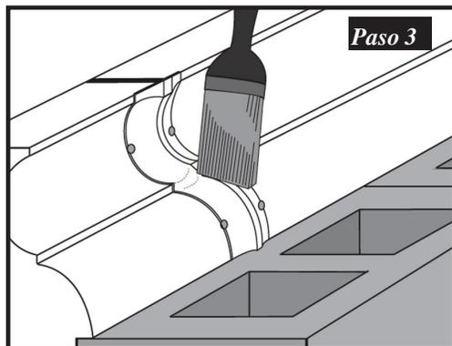
**Paso 3.** Aplique una capa de "Frontier Release Agent" a Chamfer Clip y deje secar.
